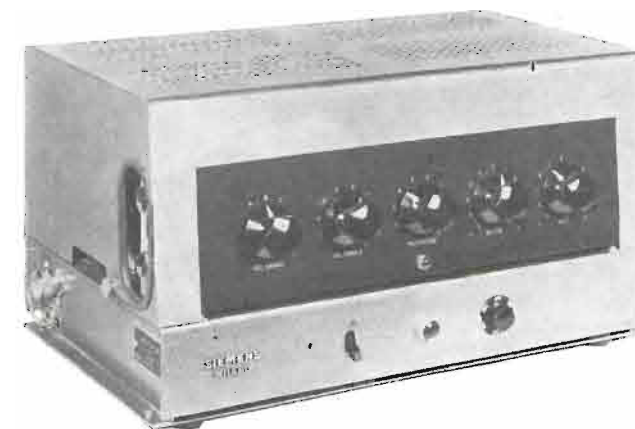
Amplificatore da 30 o da 60 W completo di preamplificatore.
